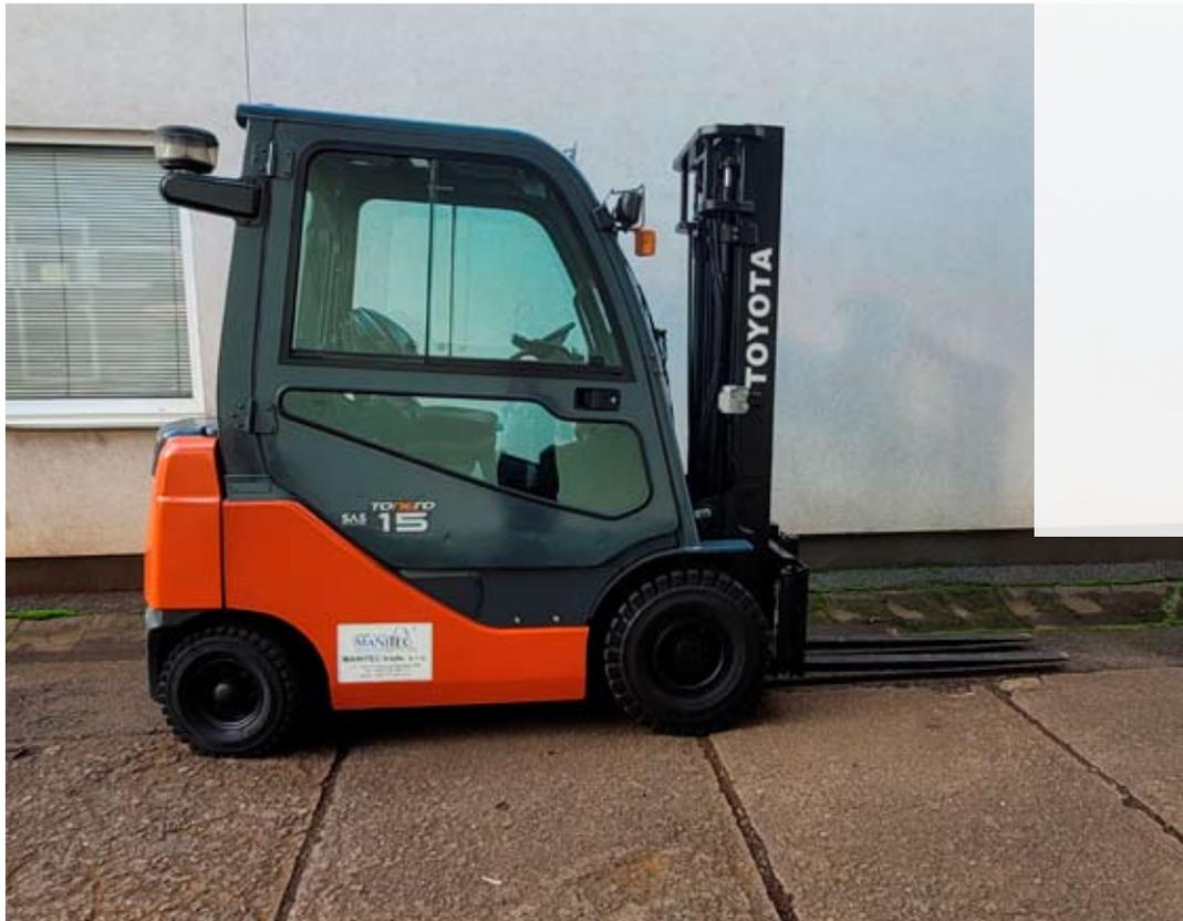
Für den Materialtransport wurde ein zusätzlicher Gabelstapler Toyota 02-8FDF18 mit Dieselmotor gekauft. Er hat eine Tragfähigkeit von 1750 kg und ist mit einer Hebevorrichtung in Duplex-Ausführung mit einer Höhe von 3300 mm ausgestattet. Die Ausstattung dieses Staplers umfasst Luftreifen, die stoßdämpfend sind und somit die Bewegung auf unebenem Untergrund möglich ist.
